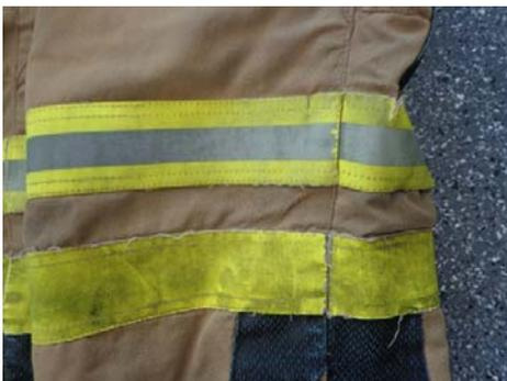
**Beispiel:** Aufgeplatzte Nähte und Risse bei Reflexstreifen aufgrund mechanischer Reibung
