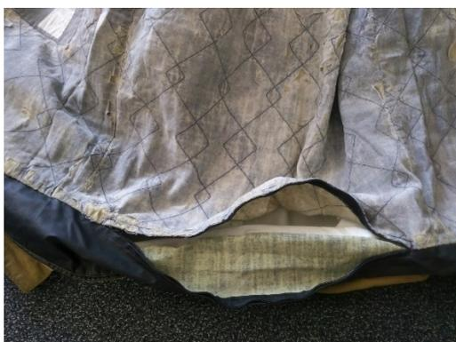
**Beispiel:** Zersetzung Futter aufgrund Reaktion von Schweißrückständen (Salze)
