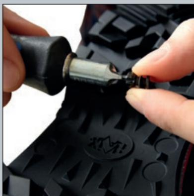
2. Der Kopf des Spikes wird im dazugehörigen Montageschlüssel positioniert.
