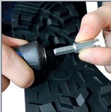
1. Der Montageschlüssel wird aus den beiden Einzelteilen zusammengebaut.
