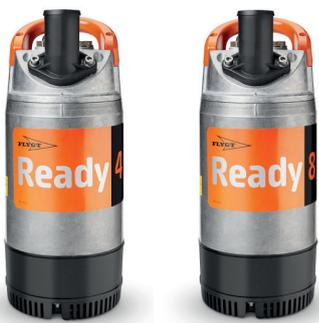
Mit nur 12 bzw. 14,5 Kilo Gewicht sind die Ready 4 und 8 für die Entwässerung von Baustellen, bei Überflutungen und für ähnliche Anwendungen ideal. Sie sind für abrasive Flüssigkeiten in den pH-Bereichen 5-8 und mit Partikelgrößen bis zu 5 mm geeignet.
