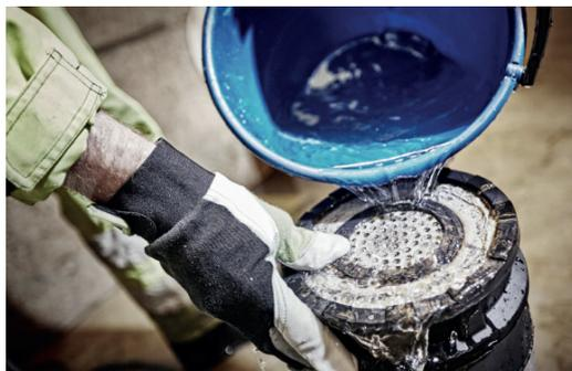
**Pumpe bei niedrigem Niveau starten:** um die Pumpe bei niedrigem Wasserstand zu starten, muss die Pumpe saug- oder druckseitig befüllt werden (siehe bild oben).
